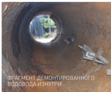
ФРАГМЕНТ ДЕМОНТИРОВАННОГО ВОДОВОДА ИЗНУТРИ
